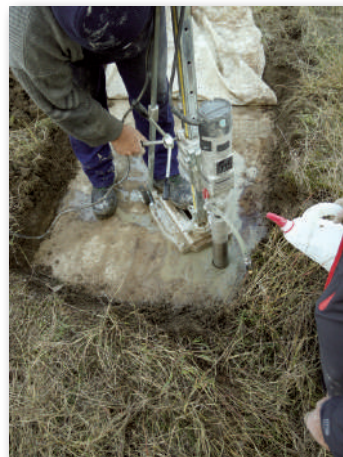
Вземане на образци от циментопочвен противифилтрационен екран след 51-годишна експлоатация
