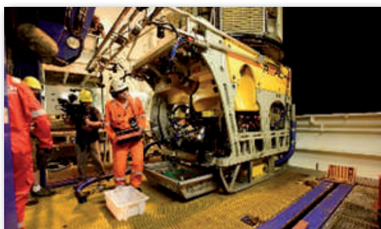
Подготовка за спускане на „Спортер“ – дълбоководен дистанционно управляем апарат работен клас (ROV), с който могат да се документират останки от корабокрушения на дълбочина над 2000 м
