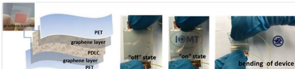
Интегриране на прозрачни, проводящи електроди от графен в гъвкави устройства
