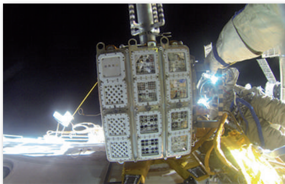
В центъра е платформата EXPOSE-R2. Приборът R3DR2 е в нейния горен десен ъгъл
