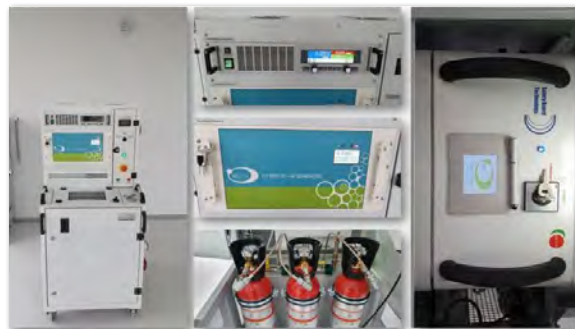
Водороден енергиен цикъл с обща мощност 1 kW и енергиен буфер от 3.2 kW/h при налягане от около 5 bar
