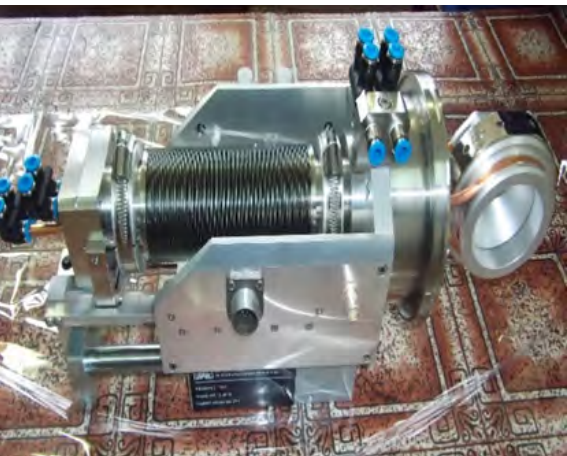
Охлаждаеми цилиндри на Фарадей за измерване йонния ток в канала за транспортиране на снопа и рофилметри за контрол на профила и размерите на снопа на новия високоенергиен циклотрон в ЛНФ на ОИЯИ, изработени в Базата за внедряване – Физика
