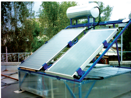
Фотоволтаичен генератор с 300 пъти концентрация на слънчевата енергия
