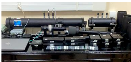
University of Niš, Faculty of Occupational Safety: Прецизно определяне на звукоизолационните свойства с Transmission Loss Tube Kit, type Bruel&Kjaer 4206-T.
