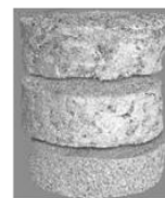
Институт по механика – БАН: Микрокомпютърна томография и 3D реконструкция за крайно-елементен анализ на порьозни акустични материали.
